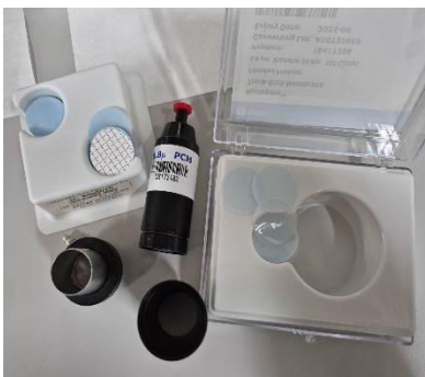
Figure 48 - supporto e membrana/ filtro di prelievo
