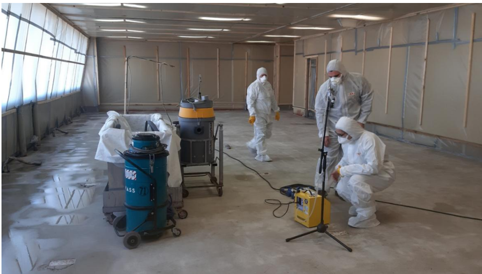
Figura 49 - campionamento di restituibilità
