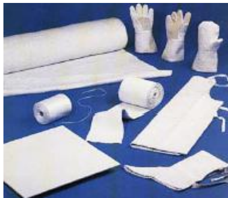
Figure 21 - corde isolanti in pure fibre di amianto (sx); filati, tessuti, nastri indumenti (dx) (fonte: Inail, Conoscere il rischio/polveri e fibre/amianto)
