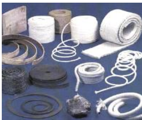
Figure 21 - corde isolanti in pure fibre di amianto (sx); filati, tessuti, nastri indumenti (dx) (fonte: Inail, Conoscere il rischio/polveri e fibre/amianto)
